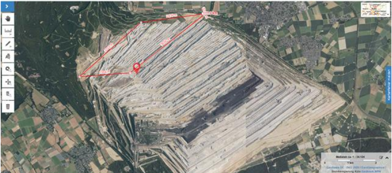
Abbildung 3: Anhand der Ausdehnung der überhöhten Innenkippe in Entfernungsangaben ist der maximal mögliche Rückverlagerungsraum zum gegenwärtigen Stand /Frühjahr 2020 ersichtlich. (Unter der Annahme, der Tagebau käme bereits in der nächsten Zeit auf Grund fehlender Betriebsgenehmigungen zum Erliegen. Es ist erkennbar: Bereits jetzt ließe sich die von uns vorgeschlagene Rückverlegung des Innenkippen-Böschungsfußes um 500 bis 1000 m realisieren.) Bildquelle: https://www.tim-online.nrw.de/tim-online2/ (am 27. Mai 2020 entnommen)
