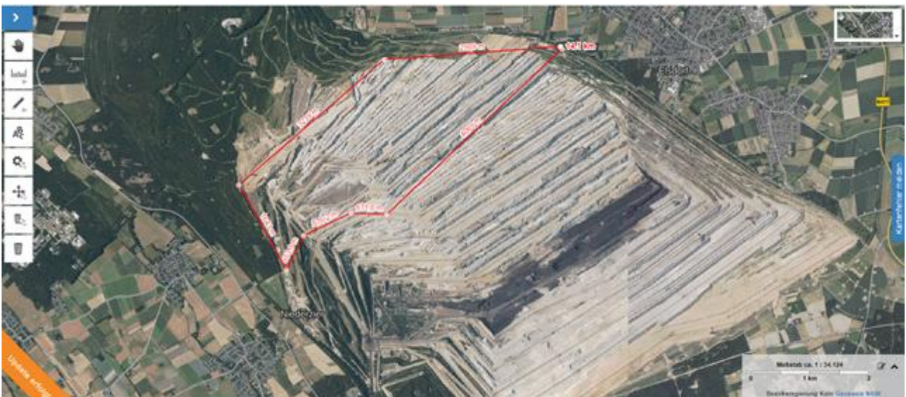
Abbildung 4: Voraussichtliche Ausdehnung der im Jahr 2030 noch unkultivierten Bereiche der überhöhten Innenkippe oberhalb GOK. Innerhalb dieses Areals lässt sich die von uns vorgeschlagene Rückverlegung des Innenkippen-Böschungsfußes um 500 bis 1000 m realisieren. Dadurch brauchen bis zum Abschluss der Wiederentnahme/Rückverfüllung der Abraummassen auf dem obersten, an die Sophienhöhe grenzenden Bereiche dieses Areals keine Rekultivierungsarbeiten begonnen werden. Diese können daran anschließend um so gründlicher durchgeführt werden. Eindeutig erkennbar ist, die bereits rekultivierten Bereiche der Sophienhöhe bleiben zur Gänze unberührt. Bildquelle: https://www.tim-online.nrw.de/tim-online2/ (am 04. Juni 2020 entnommen)
